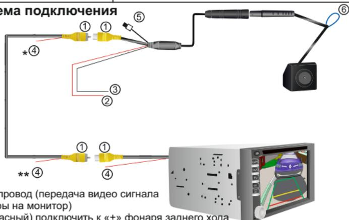
1. Видео провод (передача видео сигнала с камеры на монитор)
